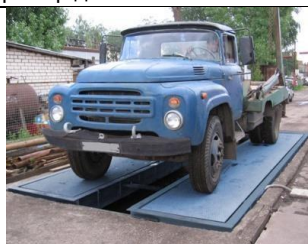
Модификация с рамой для установки в разрыв дорожных плит
